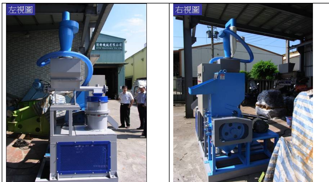
圖 2 本研究之移動式 RDF 機具實體外觀
