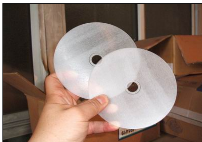
圖 4 研磨後之廢光碟片
