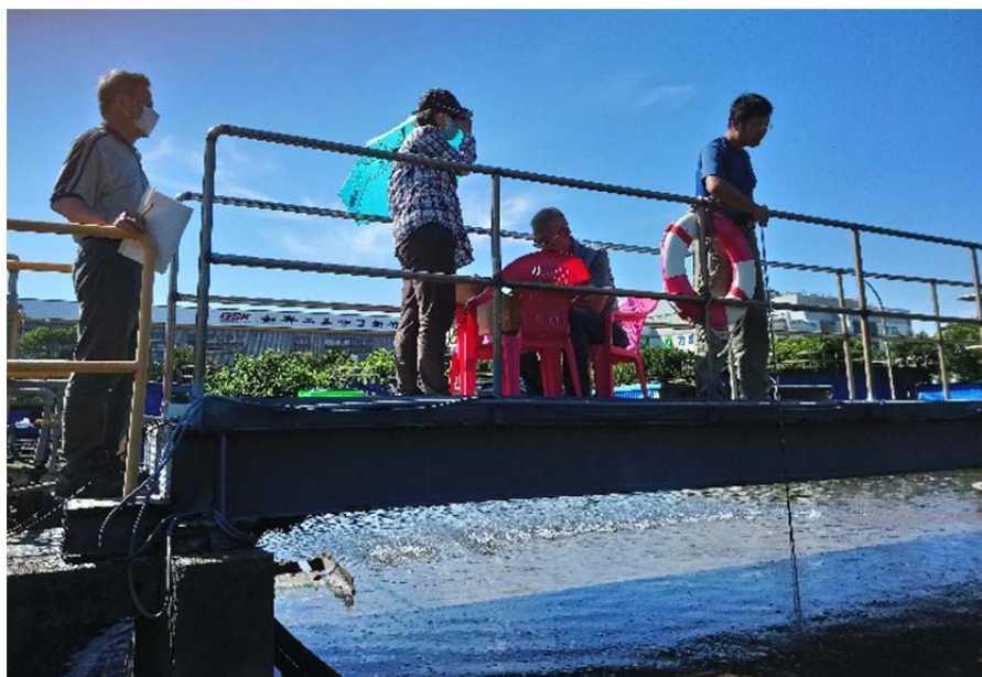
圖七 以 PC 陳技術進行二沉池水流型態分析試驗
