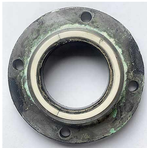
圖 19 損壞的機械軸封顯示軸封面破裂及塗料堆積
