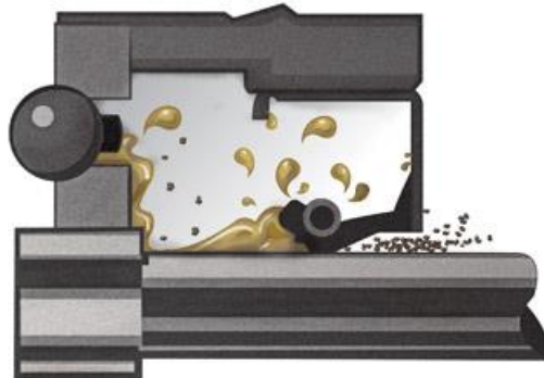
圖 27 泵軸上的唇形軸承軸封刻劃出的溝槽
