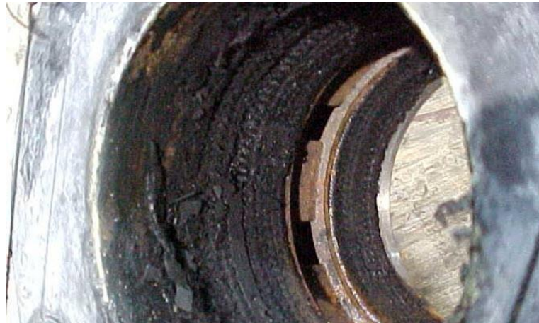
圖 23 填料函截留固體
