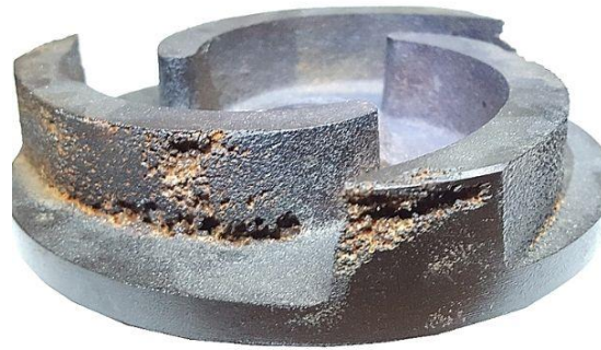
圖 10 泵浦乾轉會導致葉輪孔蝕
