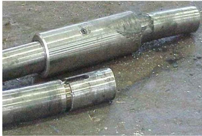
圖 25 泵軸彎曲(故意裁斷以便移除葉輪)
