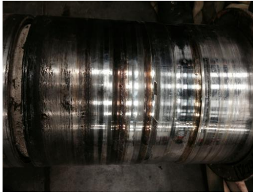
圖 28 軸套顯示深槽，表示填料過度磨損
