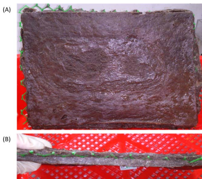
圖 6 好氧固定生物板 (A) 側視圖 (B) 俯視圖
