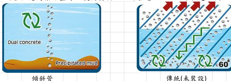
圖-6 傾斜管增加沉澱效率概念圖
